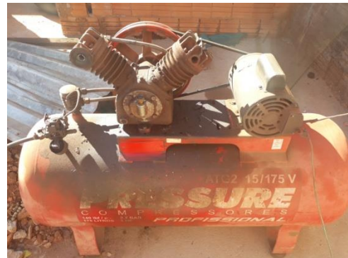
Figura 3: Pressostato, válvula de segurança e manômetro
