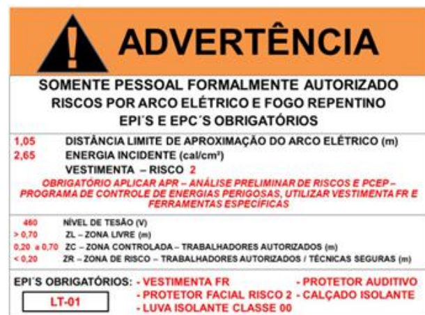
Figura 3: Placa de advertência dos painéis
