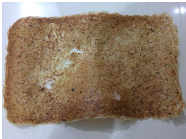
Figura 1 – Bioplástico com fibras de coco mais trituradas.
