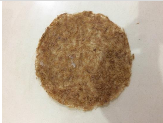
Figura 2 – Bioplástico com fibras de coco menos trituradas
