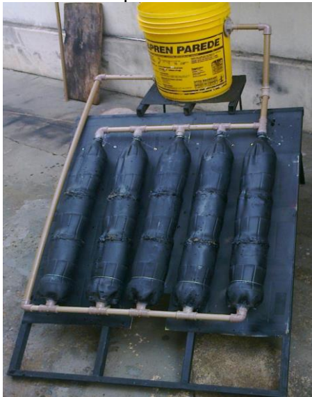
Figura 1 – Planta piloto- Concentrador solar
