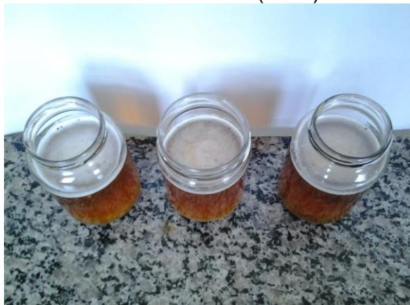
Determinou-se o fim do processo fermentativo ao segundo dia quando verificou-se perda da constância de bolhas de CO<sub>2</sub> liberadas pelo sistema de escape, ocorrendo portanto no oitavo dia após ter-se fechado o fermentador.
