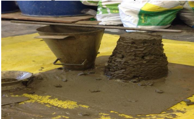
Figura 2 – Teste do Slump
