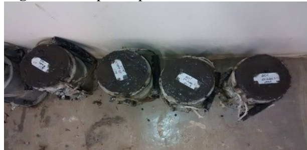
Figura 1 – Corpos de prova de concreto com CBC
