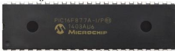
Figura 1: Micro Controlador 16F877A
