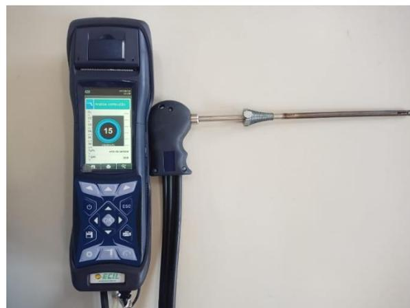
Figura 2: Analisador de gases de combustão ECIL Chemist 606 HC. Acervo do autor, 2023.
