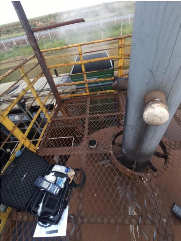
Figura 3: Coleta de amostra com equipamento ECIL Chemist 606. Acervo do autor, 2023.
