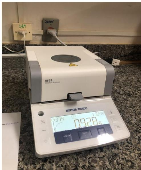
**Figura 2** – Balança Mettler Toledo determinadora de umidade. Fonte: Autor.
