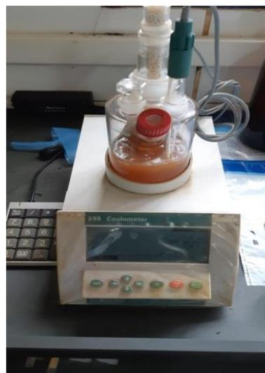
Figura 4: Aparelho 899 Coulometer Karl Fischer para a medição do teor de água.
