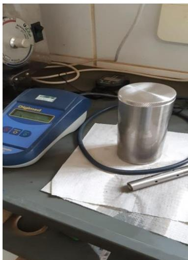
Figura 2: Condutivímetro Coulometer Karl Fischer. Medição do Diesel S-10 e S-500.
