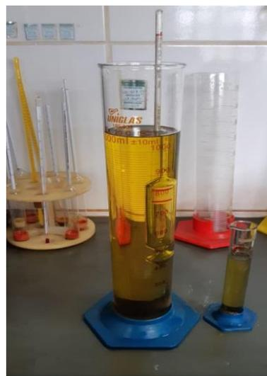
Figura 1: Medição da Densidade do Diesel S-10.
