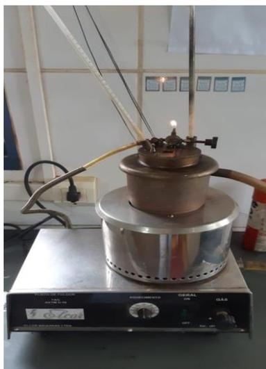
Figura 5: TAG para determinar o Ponto de Fulgor do Diesel S-10 e S-500.
