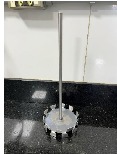
Figura 3: Impelidor tipo Cawless de 11,22 cm de diâmetro.
