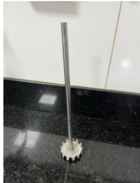
Figura 2: Impelidor tipo Cawless de 5,21 cm de diâmetro.
