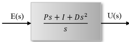
Figura 10 - Função de Transferência do Controlador PID, C(s) em forma de equação independente.
