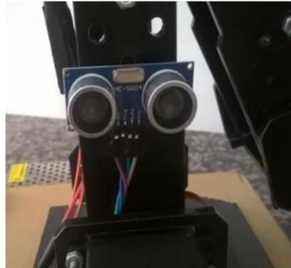
**Figura 9** - Sensor Ultrassônico
