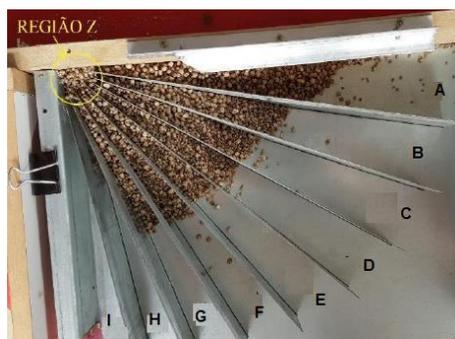
**Figura 7** – Imagem da obtenção de frações da pilha para medida dos índices de segregação.
