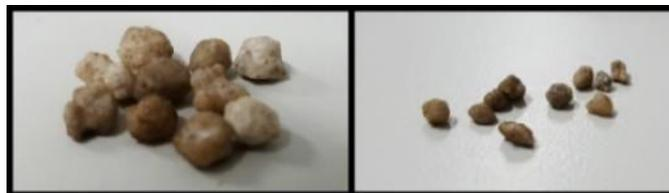
**Figura 6** – Determinação da esfericidade (lado esquerdo: Amostra A; lado direito: Amostra B)
