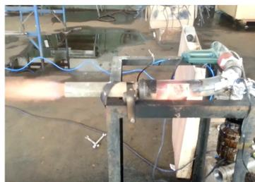
Figura 7. Teste de queima do bio-óleo em escala laboratorial.
