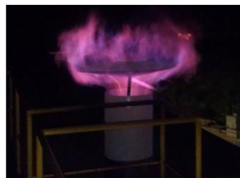
Figura 8. Teste de queima do bio-óleo com eucalipto Grandis.
