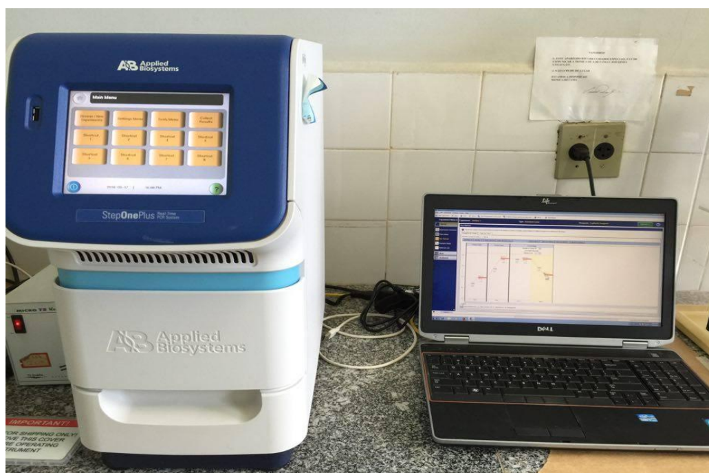
Figura 2: StepOne™ Real-Time PCR System, Thermo Fisher Scientific. Termociclador utilizado para realização dos testes de PCR-RT.
